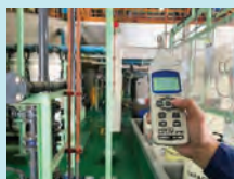
จุดตรวจวัดที่ 2 ห่างจากแหล่งกำเนิดประมาณ 8 เมตร 79.6 dB(A)
