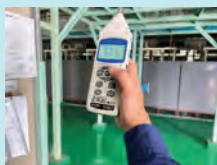
จุดตรวจวัดที่ 1 ห่างจากแหล่งกำเนิดประมาณ 4 เมตร 83.1 dB(A)
